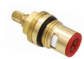
Castelo Cerâmico On/Off 1/20" - 1/4 volta - Série Xik
